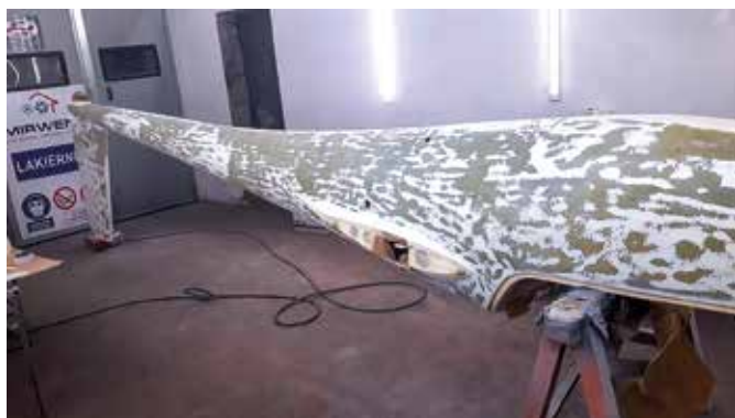
Widok kadłuba po usunięciu starej powłoki i przygotowywany do oględzin struktury
