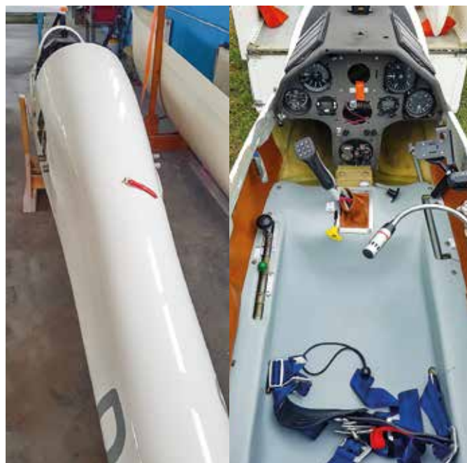
Widok kadłuba po usunięciu starej powłoki i przygotowywany do oględzin struktury
