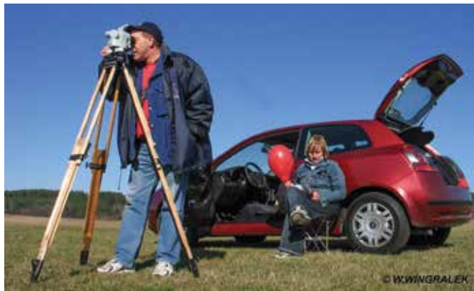
Pomiar siły i kierunku wiatru za pomocą teodolitu meteorologicznego i balonika wypełnionego helem na lotnisku w Lisich Kątach w czasie Grudziądzkich Zawodów Balonowych. Na zdjęciu meteorolog Andrzej „Szaman” Wojtyniak i jego pomocniczka Aleksandra Maciejewska
