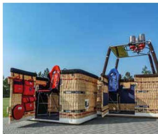
Zdjęcie kosza przystosowanego do lotu osób niepełnosprawnych
